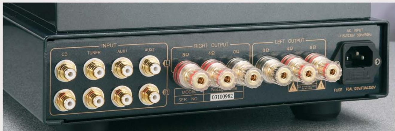
Sul pannello posteriore si notano i morsetti di uscita con il positivo separato per diffusori da 8 e 4 ohm. Gli ingressi sono quattro, tutti di linea, dotati di connettori con isolatori in teflon.
