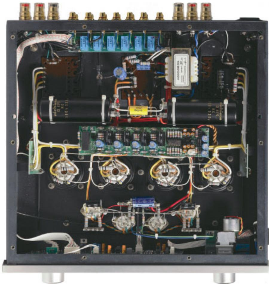
amplificateur intégré possède une commande à distance, le contrôle de volume ALPS est évidemment motorisé et la sélection des entrées se fait par relais mécaniques. La connectique, pour sa part, est d'excellente qualité et offre des bornes pour une charge de quatre ou huit ohms.
