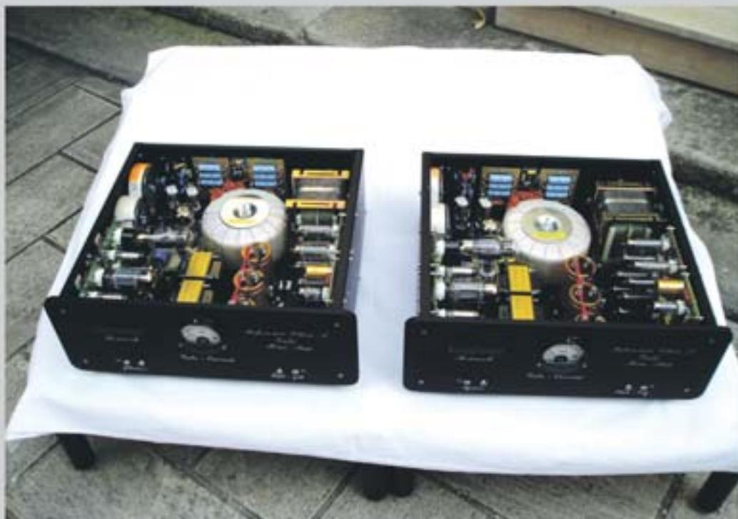
Amplificatori monofonici a valvole cablati in aria con componentistica selezionata e con trasformatori d'uscita costruiti in mu-metal a doppio nucleo 'C'. Funzionamento in classe A
