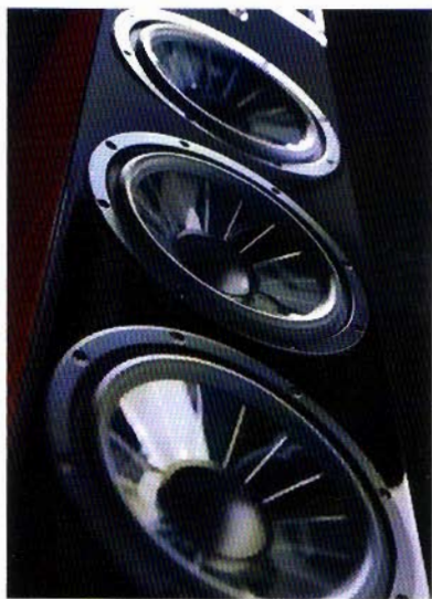
Les trois unités de grave utilisent des membranes propriétaires à base de TPX et de fibres de verre. Elles sont câblées électriquement en parallèle mais les deux du bas ont leur propre volume de charge, séparé du volume de travail du troisième transducteur.
