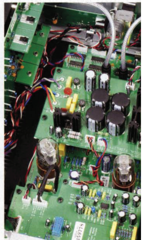
Cooler Zündkabel: Vom röhrenbestückten Vorstufenmodul geht's per Cinch-Leitung (hinten) zu den Endstufen.
