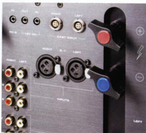
Auch die blaue Klemme ist „heiß“: Der FBI verstärkt symmetrisch, von den XLR- und CAST-Eingängen (darüber) bis zum Ausgang.
