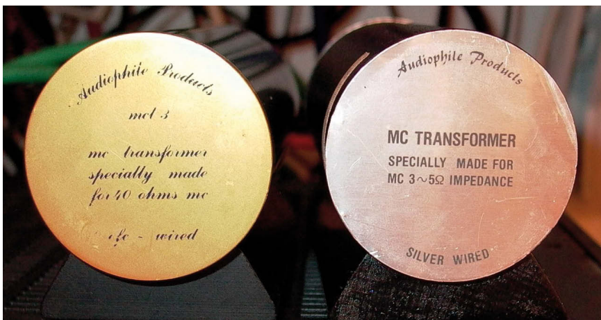
Step Up MCT-1 con avvolgimenti in argento a sinistra e un MCT-3 in rame a destra.
